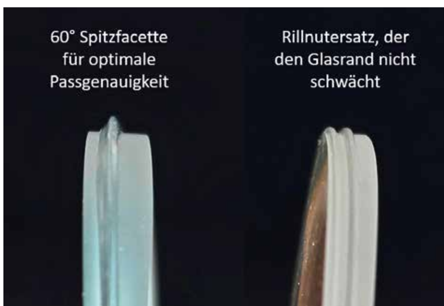
Abb. 7: Spitzfacette und Rillnutersatz additiv aus elastischem Material hergestellt. Der kleine Spitzenwinkel bei der links dargestellten Facette sorgt in Kombination mit der Materialnachgiebigkeit für eine perfekte Anpassung zwischen Fassungsnut und Glasrand.
