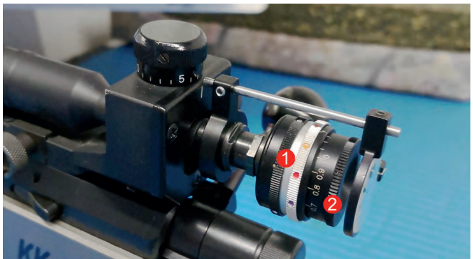
Abb. 16: Der am Diopter montierte Zielglasring. Erkennbar sind außerdem das Einstellrad für die Farbfilter (1) und der Verstellring der Irisblende (2).
