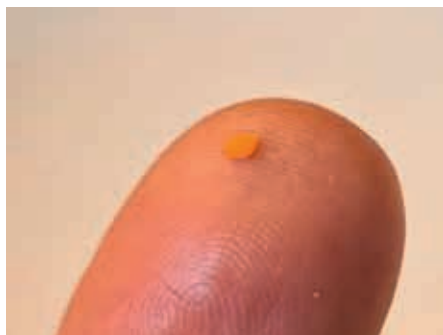
Abb. 2: Der implantierte Mikrochip ist zwei mal zwei Millimeter groß und 30 Mikrometer dünn. Er umfasst in der ersten Version 378 Pixel.
